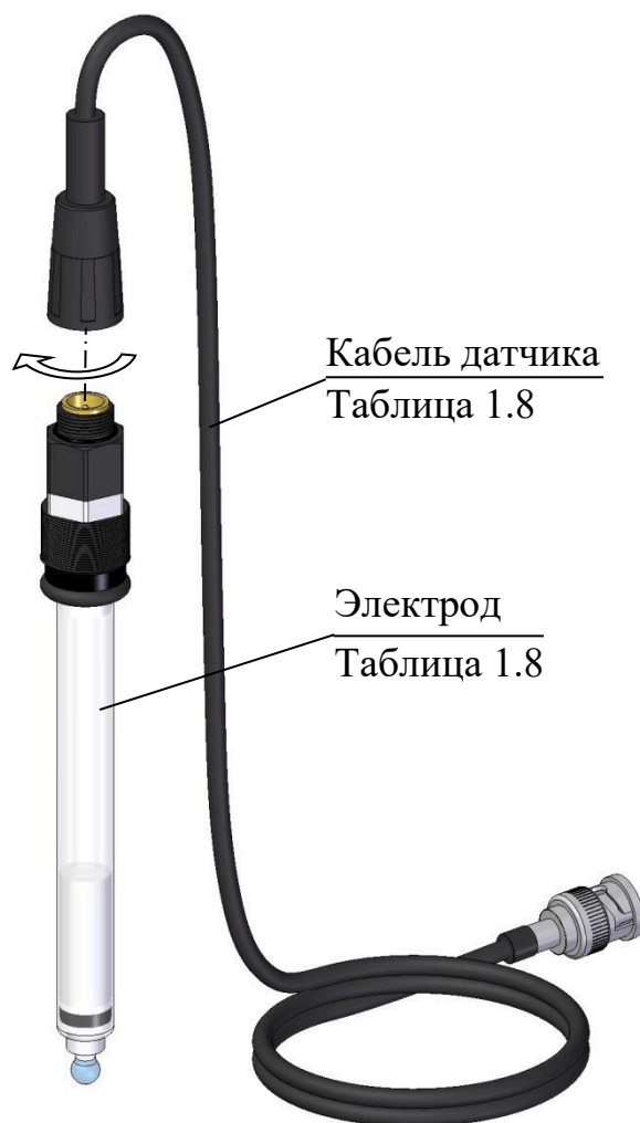
Рисунок 1.9 – Подключение кабеля датчика к комбинированным электродам
