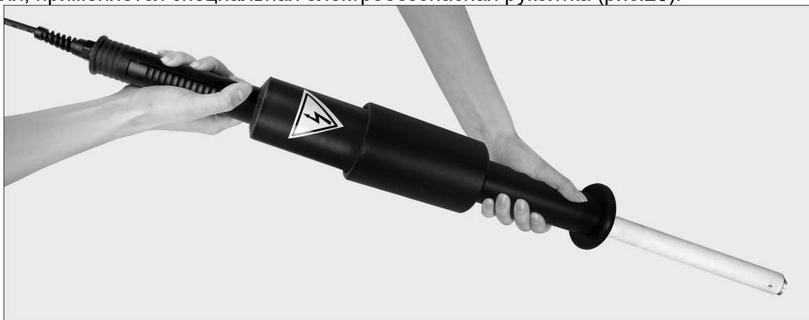
Рис. 26. Высоковольтный трансформатор - держатель с надетой электробезопасной рукояткой
