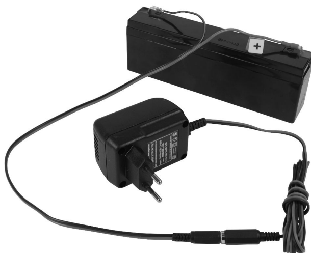
Рис. 30. Внешний заряд аккумулятора: подсоединение к переходному разъему на кабеле зарядного устройства соединительного кабеля с клеммами для подключения к аккумулятору и подсоединение клемм кабеля зарядного устройства к выводам аккумулятора
