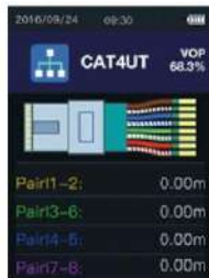
Измерение сетевого кабеля
