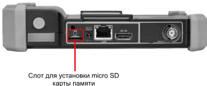
Рис. 21 Установка карты в Micro SD слот
