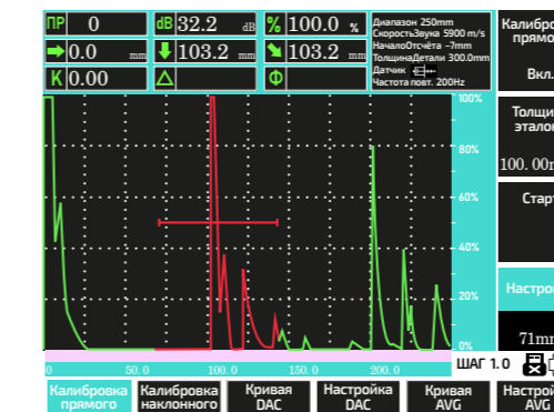
Рис. 6. Настройка положения строба
