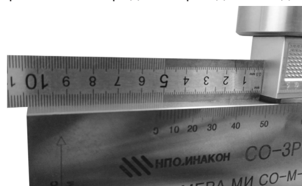
Рис. 17. Измерение передней кромки
