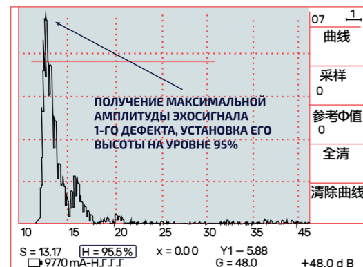
Рис. 30 Эхосигнал первого дефекта
