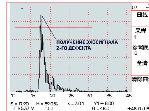
Рис. 32 Эхосигнал 2-го дефекта
