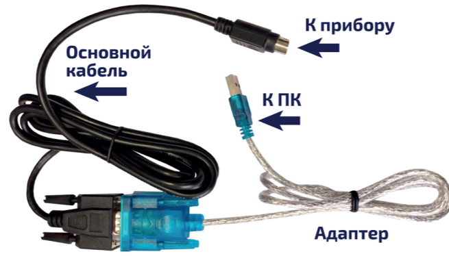
Рис. 59 Соединение основного кабеля и адаптера
