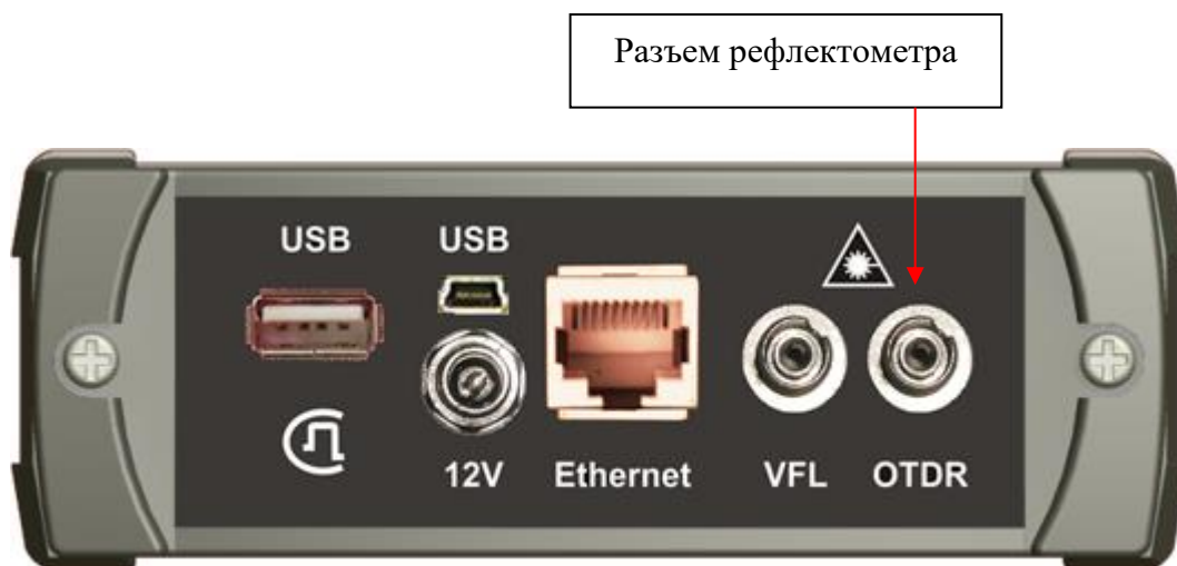
Рис. 69. Подключение оптического волокна к OTDR.
