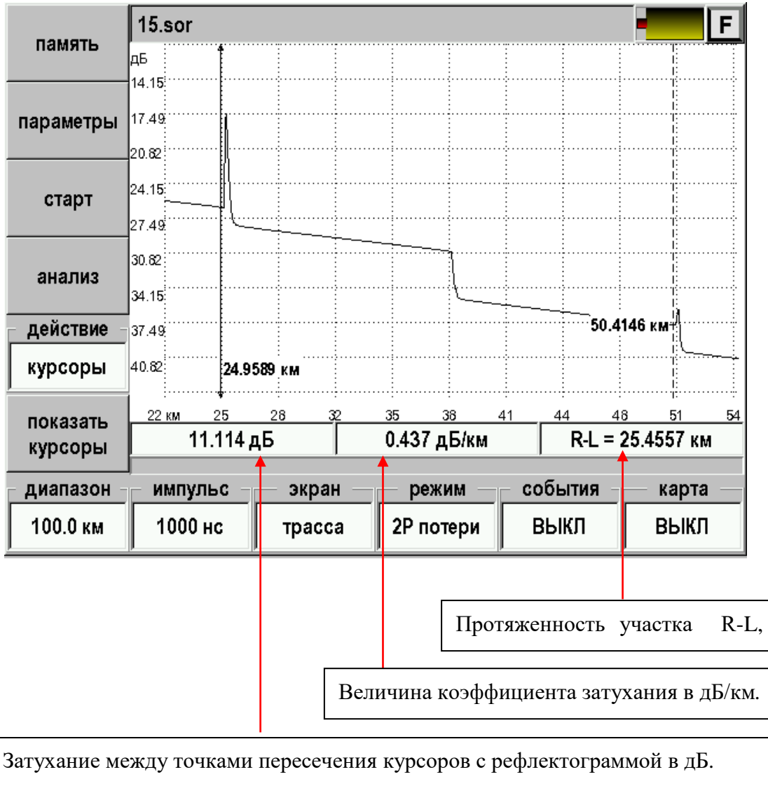
Рис. 31. Измерение затухания по двум точкам.
