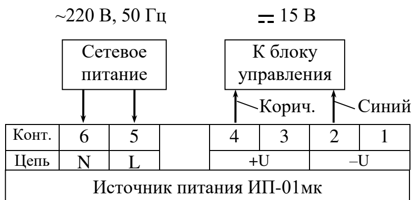
Рисунок 2.14 – Схема подсоединения кабелей к источнику питания ИП-01мк
