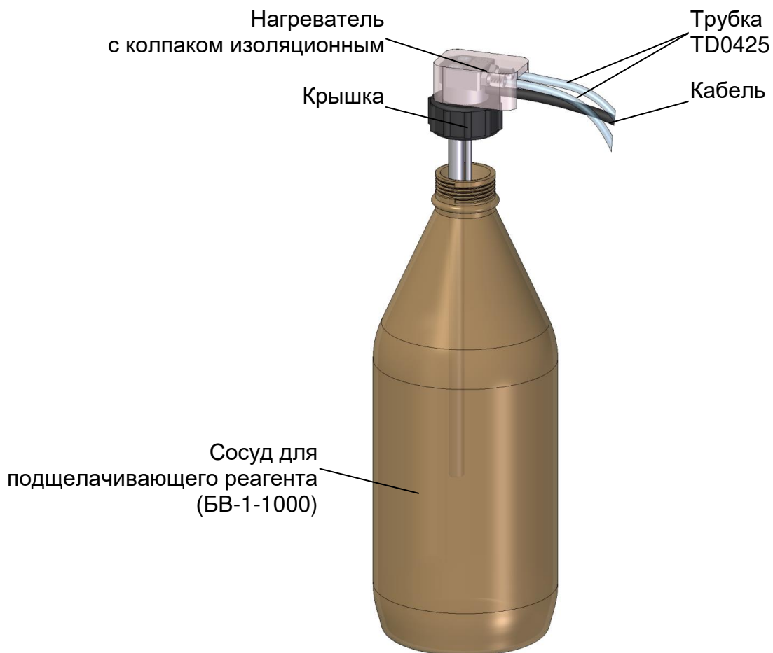
Рисунок 2.13 – Заливка подщелачивающего реагента в сосуд гидропанели ГП-1002Т
