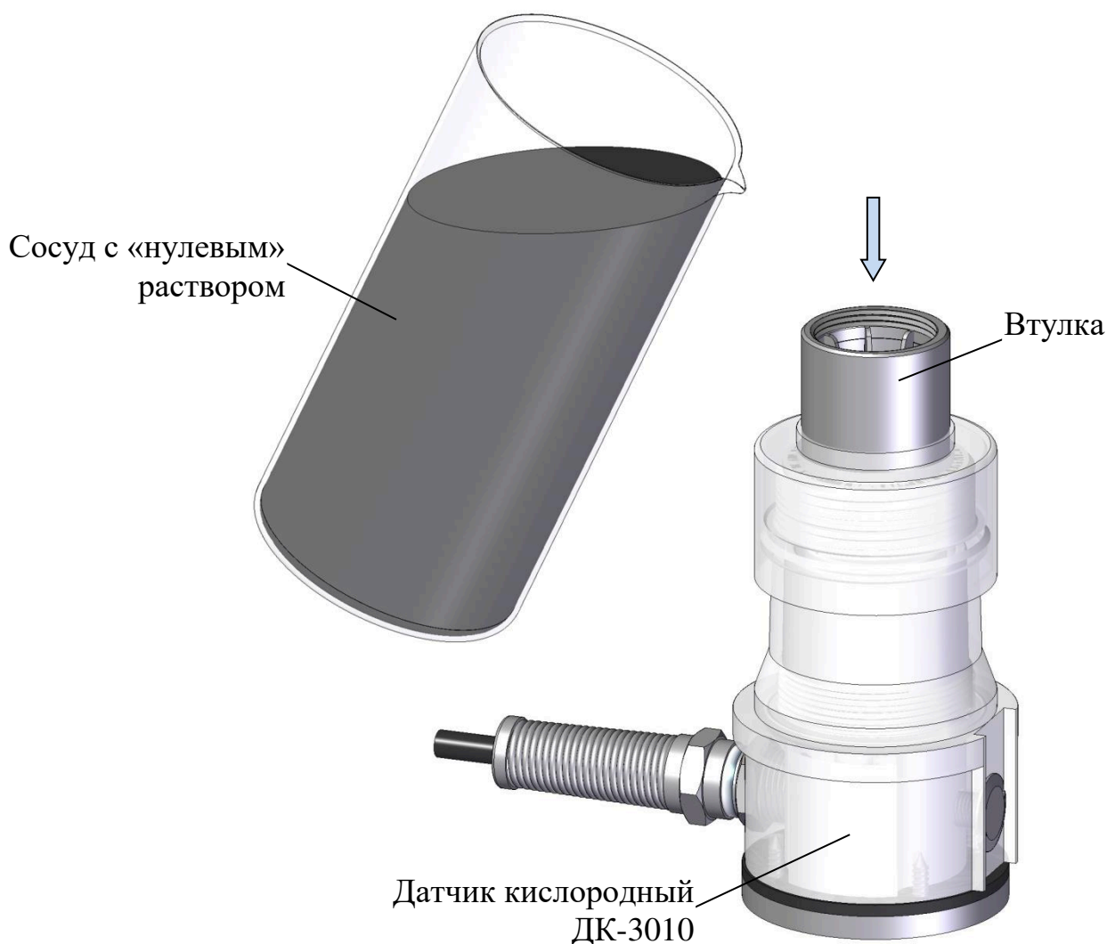
Рисунок 2.2 – Проверка показаний в «нулевом» растворе
