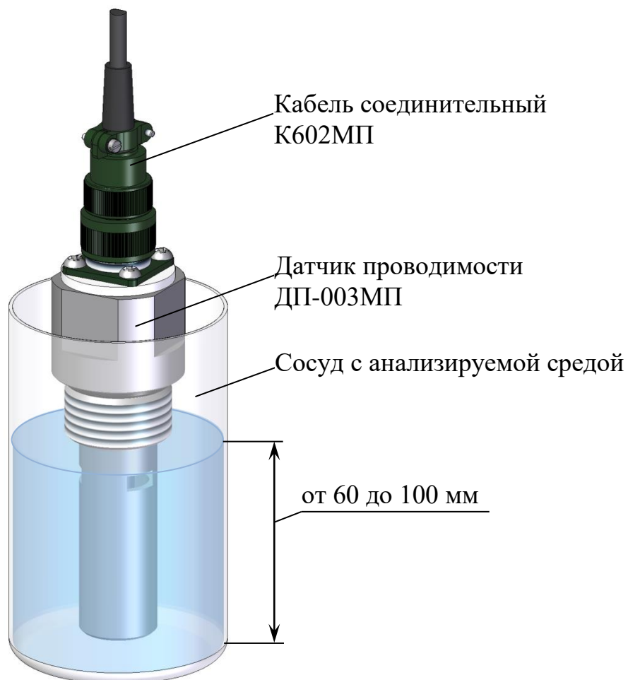
Рисунок 2.8 – Расположение датчика проводимости ДП-003МП в сосуде
