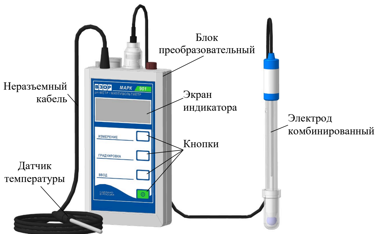
а) рН-метр/милливольтметр портативный МАРК-901
