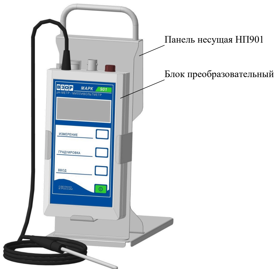
Рисунок 2.2 – Панель несущая НП901 с установленным блоком преобразовательным
