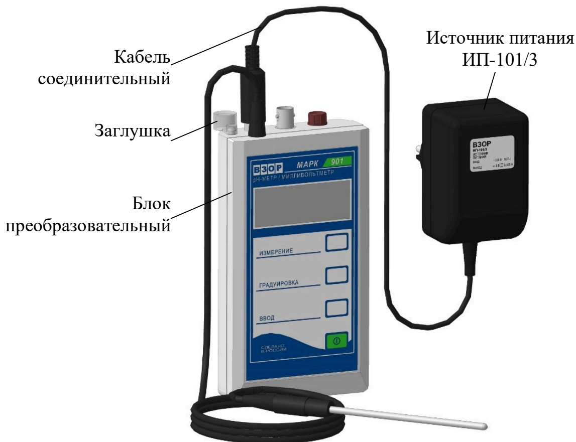
Рисунок 3.1 – Зарядка аккумуляторных батарей
