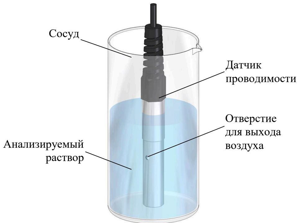
Рисунок 2.3 – Проведение измерений погружным методом
