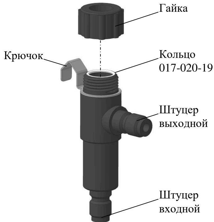
Рисунок 2.5 – Кювета проточная ВР41.15.310
