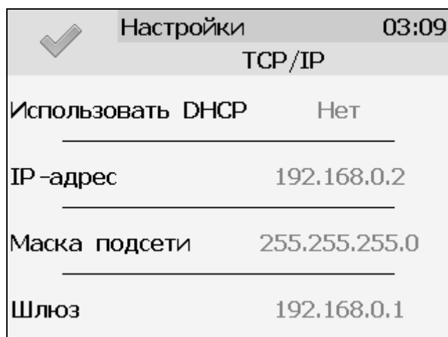
Рисунок 6.25 Экран настройки TCP/IP
