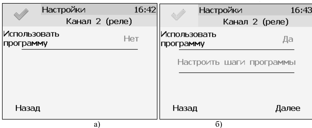
Рисунок 6.16 Вид экрана активации программы регулирования
