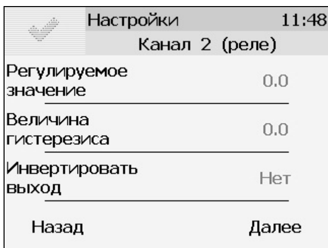
Рисунок 6.15 Вид экрана настройки гистерезис
