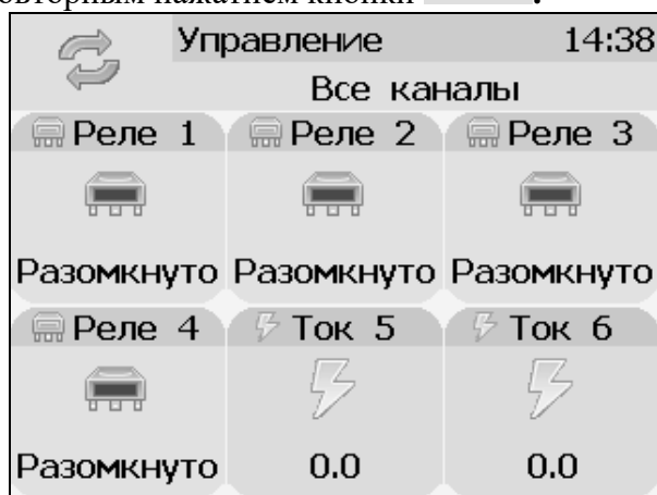
Рисунок 6.10 Вид экрана состояния каналов управления
