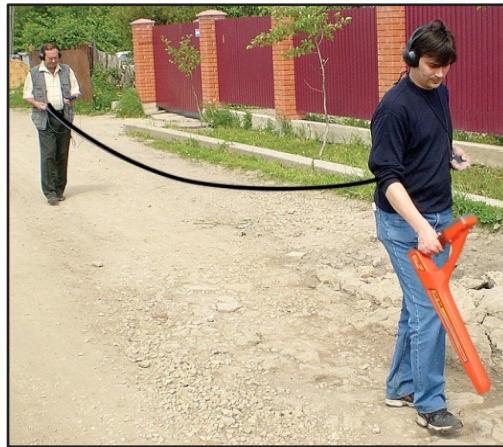
Рисунок 22 – Обследование при помощи ДОДК-117
