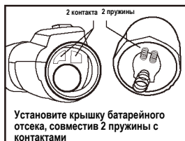
Прижмите и поверните крышку, чтобы зафиксировать ее на корпусе прибора
